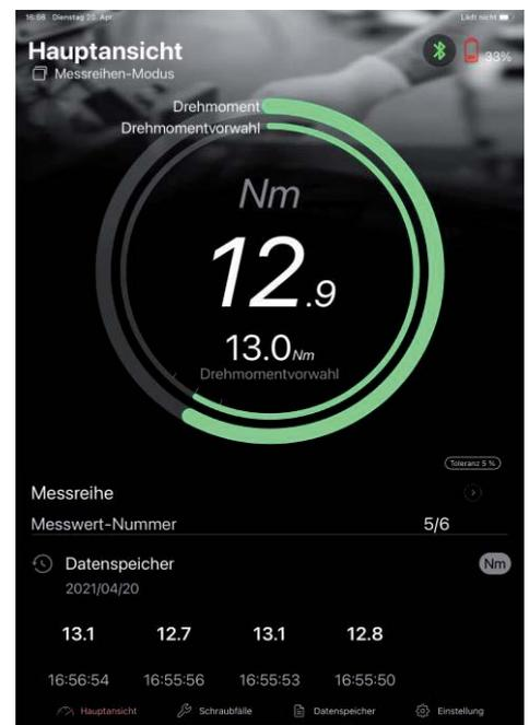
Die Messreihen mit jeweils 6 Einzelwerten können nach Abschluss der Arbeiten im Datenspeicher kontrolliert werden.
